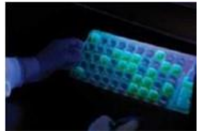
1. Imatges: recollida de mostres d'aigua i anàlisis dels indicadors microbiològics al laboratori pel mètode del Número Més Probable (NMP)
