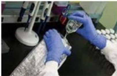
1. Imatges: recollida de mostres d'aigua i anàlisis dels indicadors microbiològics al laboratori pel mètode del Número Més Probable (NMP)
